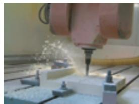
CNC- Usinage d'une planche en polyuréthane.
